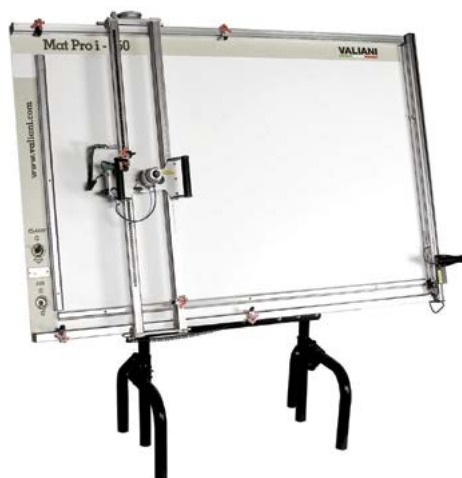
MAT PRO 150 Pnevmatski stroj za razrez kartonskih passepartujev Velikosti: 120 ali 150 cm Dodatna oprema: nastavek za rezanje 90° reza, dodatek za rezanje krogov in ovalov MAT PRO 150 Pneumatic mat board cutting machine Sizes: 120 or 150 cm Optional accessories: end trimmer 90°, oval/circle cutter attachment
