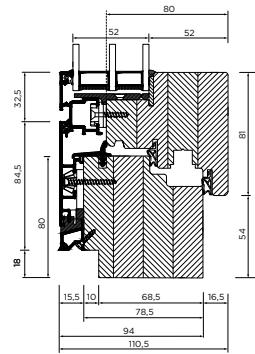
Vertikalni prerez okna
