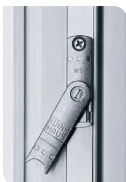
Multifunkcijski element okova udružuje zatvor poluolive u otvorenom položaju, podizač krila i stoper balkonskih vrata.
